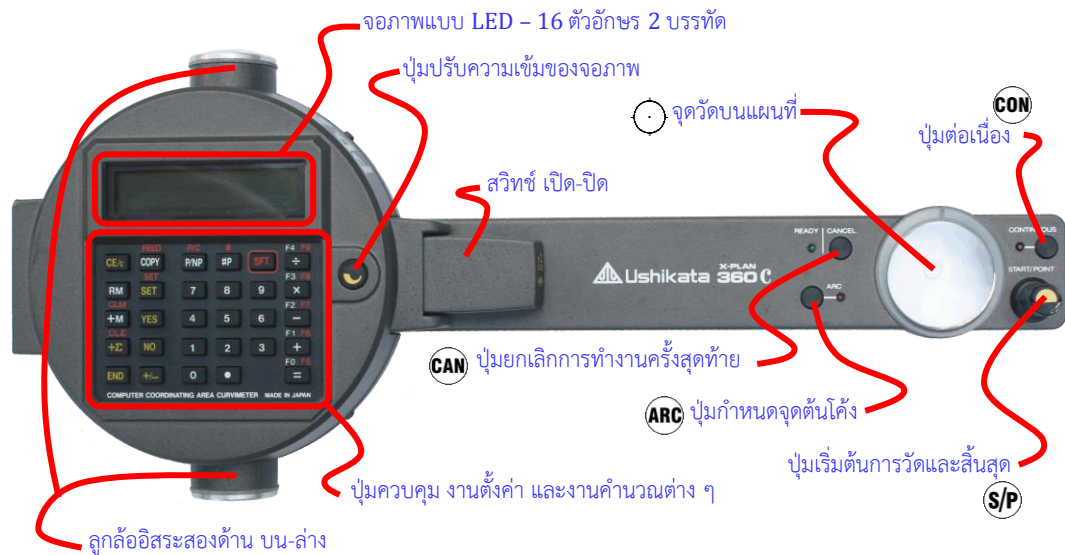
รูปที่ 5.3.2 แสดงรายละเอียดต่าง ๆ ของเครื่องมือช่วยคำนวณพื้นที่แบบดิจิทัล ความหมายของปุ่มต่าง ๆ ในส่วนควบคุม ตั้งค่า และงานคำนวณต่าง ๆ ที่กำหนดมาโดยผู้ผลิต
